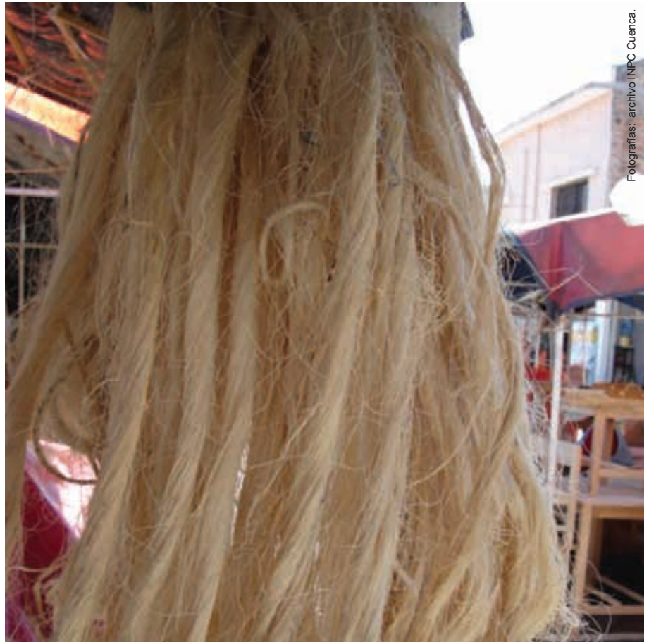
Las hebras de cabuya puestas a secar, tras el pudrimiento en los pozos.
