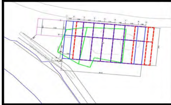
Figura # 11: Plano de la estructura de techumbre que cubre la parte más delicada del sitio.
